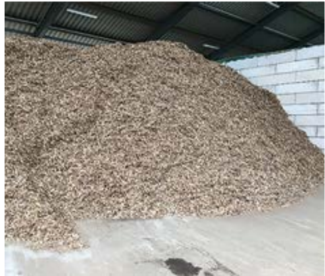
Abb. 18: Nachzerkleinertes holziges Grobkorn als Ausgangsmaterial für die Produktion von Premium-Brennstoff, Quelle: ZAKB
